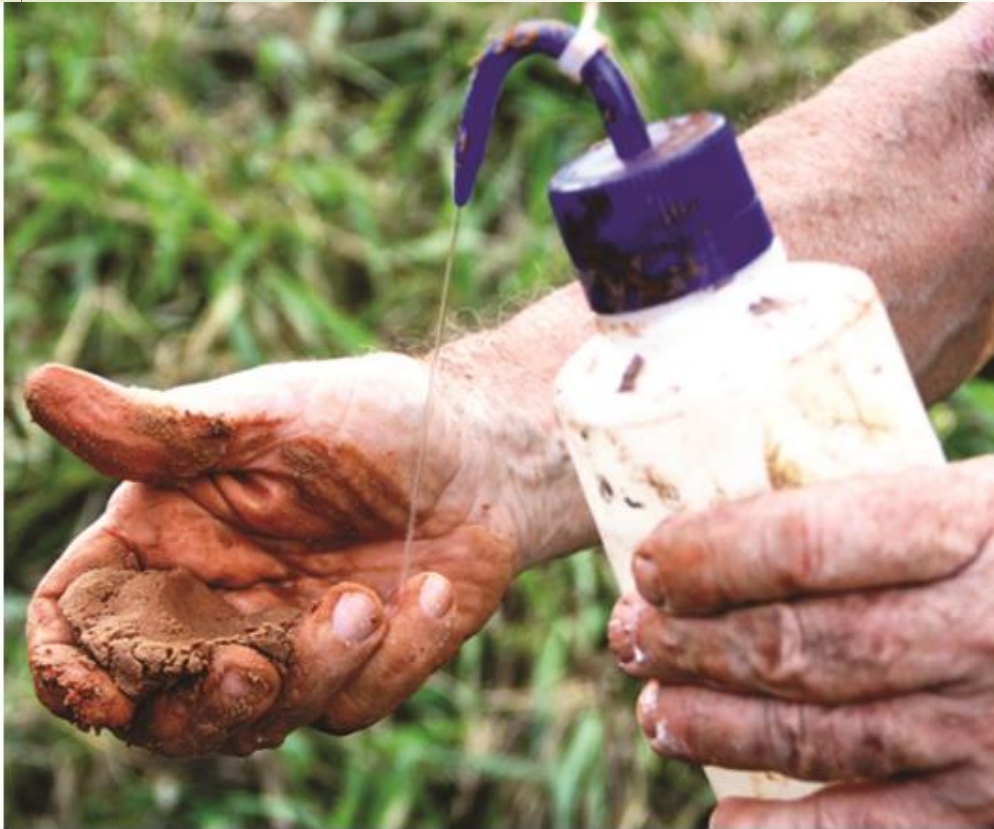
Fig. 9.5 Avaliação da classe textural e da plasticidade de uma amostra de solo, depois de umedecida e amassada entre os dedos, verificando-se a capacidade de formar “pequenos rolos” (Fotos: Rodrigo E. Munhoz)
