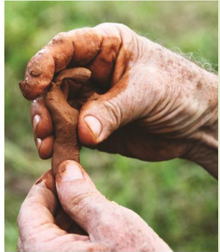
Fig. 9.5 Avaliação da classe textural e da plasticidade de uma amostra de solo, depois de umedecida e amassada entre os dedos, verificando-se a capacidade de formar “pequenos rolos” (Fotos: Rodrigo E. Munhoz)
